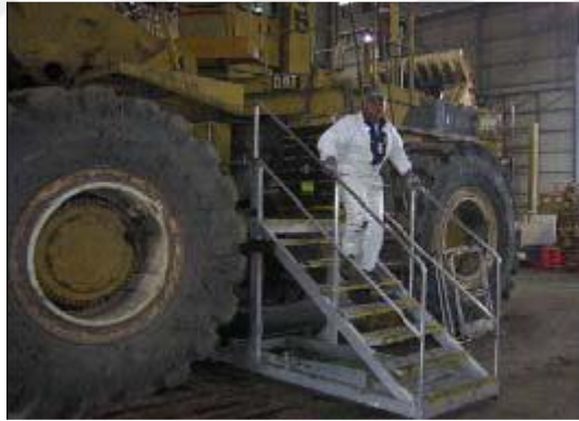
Resim 83: Ekipmana ulaşım merdiveni
