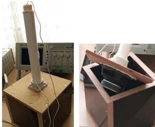
Şekil 5. Hoparlörün kutu içine alınması
