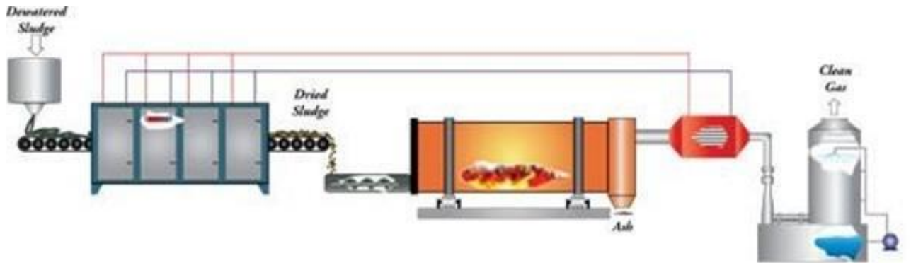
Şekil 9. Çamur kurutma sistemi
