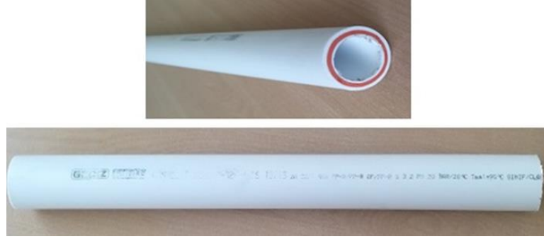
Şekil 3. Rezonans tüpü olarak kullanılan PVC boru.
