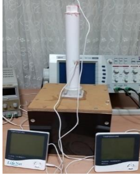
Şekil 7. Sıcaklık ölçerlerin rezonans tüpüne bağlantısı
