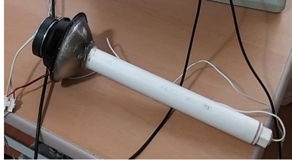
Şekil 4. Rezonans tüpü ile hoparlörün konik parça ile birleşimi.
