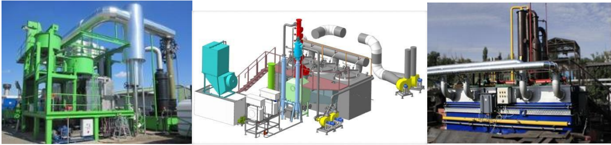
Şekil 8. Yüksek sıcaklık piroliz tesisi ve kapalı piroliz tesisi. Lastiklerin pirolizi için "Pirotext"
